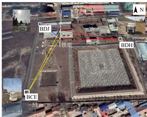
图1 2018年3月21—25日观测试验示意 (BCE、BDJ和BDH为3台WindPrint S4000型测风激光雷达,白色实线为香河102 m气象铁塔)
