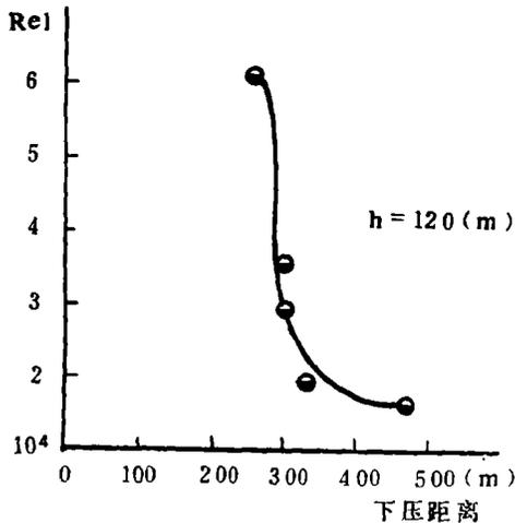
图7 烟气被下压距离与  $Re_l$  关系
